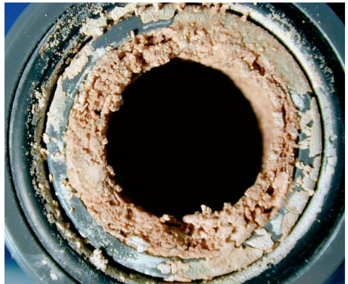
Stein des Anstosses: Der berühmte Urinstein verstopft die Leitungen (Foto Kai Udert)
